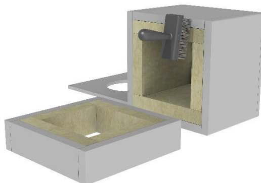
4. Zkontrolujte, zda je hrana řezu pravoúhlá. Např. ručním smetákem/vysavačem odstraňte prach.
